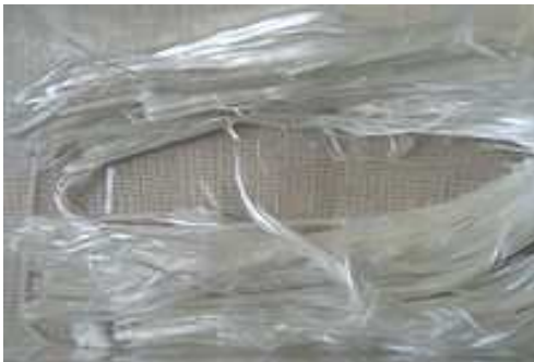
Fibre di amianto.
